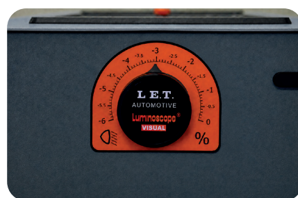
Bewegliche Projektionsfläche (MPS) mit Drehknopf und Skala
